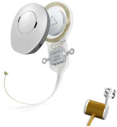
Das VIBRANT SOUNDBRIDGE Mittelohrimplantat-System sendet Klanginformationen zum Floating Mass Transducer (FMT), der das Signal in mechanische Schwingungen umwandelt, die eine Mittelohrstruktur (z. B. die Gehörknöchelchenkette) direkt in Bewegung versetzen. Der FMT kann auch direkt am runden Fenster platziert werden und so die Schwingungen direkt auf die Cochlea übertragen.
